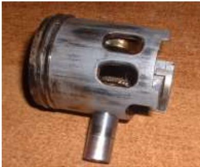
Lorsque le mélange est trop pauvre, la flamme se propage beaucoup trop vite. Lorsque l'allumage se produit trop tôt, elle atteint le piston alors qu'il n'est pas encore en phase de descente, donc capable de la fuir. Dans les deux cas, elle frappe directement la calotte du piston sous la bougie, à haute température, jusqu'à vaporiser l'aluminium. Un trou commence à se former, jusqu'à la perforation complète de la calotte (voir photo de droite).
