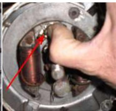
Retirer le volant qui, étant aimanté, a tendance à rester collé en place. Par précaution, récupérer la clavette (ci-contre à droite) pour ne pas l'égarer par la suite, et la coller par aimantation sur le volant. Il est temps d'examiner les pièces sous le volant, sur ces motos anciennes on verra qu'un démontage n'est pas superflu avant toute tentative de réglage...
