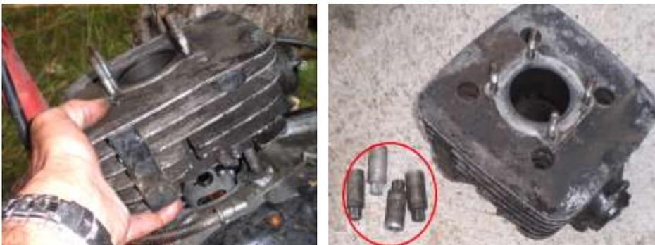
Après avoir déposé le pot d'échappement et la culasse (voir pages précédentes) détendre le câble d'embrayage à la poignée, et le retirer par sa rainure. Ensuite on aura assez de jeu pour retirer sa base de l'encoche du cylindre.
