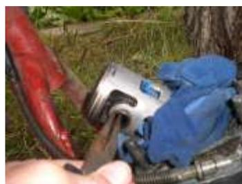
Extraire l'axe du piston en frappant doucement à l'aide d'un tournevis plat et d'un petit marteau du côté opposé à celui du jonc extrait précédemment, comme sur la photo de gauche. Ne pas frapper trop fort, il ne s'agit pas d'endommager le roulement d'embellage. Des petits coups doivent suffire. Si l'axe ne se déplace
