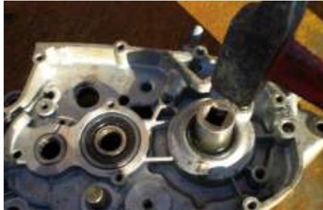
rondelles fixées sur une tige, filetée, à frapper (roulement) et un tournevis (joint spi).
