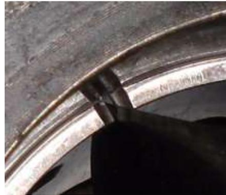
Enfin positionner un des segments bien à plat à l'intérieur du cylindre à 20 ou 25 mm du haut. On va mesurer à l'aide du jeu de cales l'espace entre les becs, dans la zone de travail, ce qui donnera une bonne idée de l'étanchéité du haut moteur.
