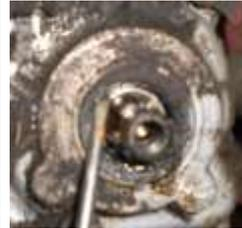
Après l'extraction du carter, retirer cette vis à l'aide d'une clé 6 pans. Pour cela, frapper un coup sec avec un marteau sur l'extrémité de la clé plutôt que de forcer, afin de bénéficier de l'inertie de la moto retenue par la chaîne sur sa roue arrière. Extraire l'entretoise, le pignon, la douille de calage,
