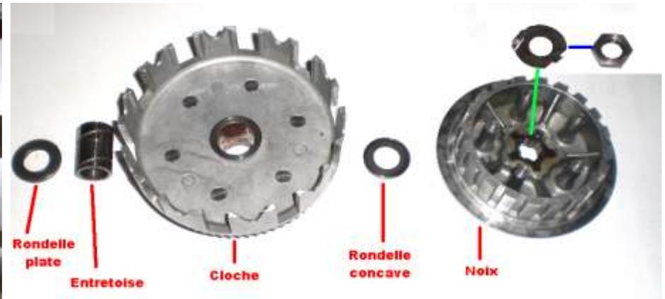
Retirer le boulon et la rondelle de blocage, puis la noix, la rondelle concave, (le coté "creux" est vers la noix d'embrayage, il faudra respecter ce sens au remontage). Extraire la cloche, une longue entretoise, et enfin une rondelle s'intercalant avant le roulement de carter (9).
