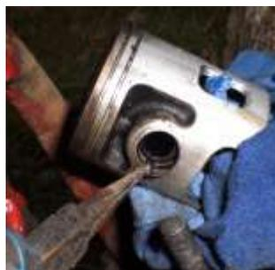
Le piston sortant du moteur, avant d'aller plus loin dans le démontage, l'entourer à sa base d'un chiffon afin d'éviter toute chute de pièce dans le bas moteur.
