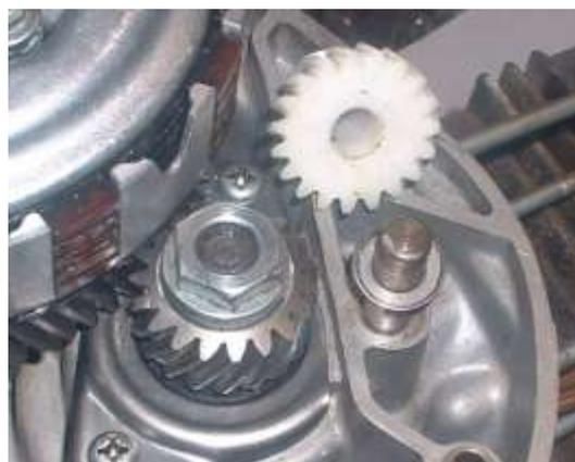
faire pivoter de manière à orienter l'arbre de sélection dans la meilleure position possible. Bloquer le contre écrou. Si le passage des vitesses persiste à être laborieux, le crochet de l'axe du sélecteur peut être usé et pousser insuffisamment le tambour, ou riper sur ses axes. Changer la pièce.
