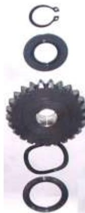
Tous les joints spi ayant été convenablement posés, ainsi que les coupelles de protection, remonter la douille de centrage d'extrémité d'embellage, son pignon sans oublier la clavette, la rondelle et le boulon d'axe. Le serrage sera effectué plus tard, lorsque l'embrayage aura été posé en coinçant un chiffon ou un clou en acier doux dans la pignonnerie.
