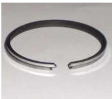
Usure contre la chemise: La largeur minimale du segment doit être de 2 mm. Plus important, cette largeur doit être constante sur toute la périphérie. Une largeur plus faible (perte de 0,15 mm, photo de droite), sur la partie positionnée au dessus de l'axe notamment, impose là aussi, et si le haut moteur n'est pas trop usé, le changement des segments. On notera que cette perte en largeur est toujours accompagnée d'une perte d'espace entre les becs (voir ci-dessus). Cela signe également un
