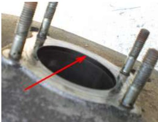
Examiner de même l'état intérieur du cylindre en descendant le piston tout en bas à l'aide du kick. De fines rayures sont normales, mais aucune ne doit être suffisamment profonde au point d'accrocher à l'ongle. Une rayure profonde diminue la puissance du moteur, n'empêche pas son bon fonctionnement, mais nécessite un démontage du cylindre (voir pages suivantes). Elle peut signaler une casse de segmentation.
