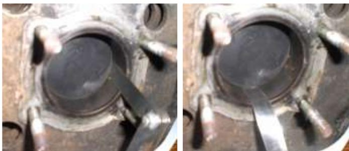
Effectuer ensuite deux mesures similaires, à 90°, dans l'intérieur du cylindre: piston en position normale, descendu à 20 ou 25 mm dans le cylindre, mesurer à l'aide du jeu de cales l'espace libre. Précédemment nous avons l'usure du piston, là nous avons celle du piston + du cylindre dans sa zone de travail. L'usure du cylindre est donc cette dernière mesure, moins celle du piston.
