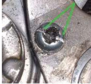
**3.** En cas d'échec, percer la vis sur 3 ou 4 mm de profondeur (photo à droite). Introduire dans le trou en frappant avec un marteau, le plus loin possible, une clé mâle 6 pans de qualité, de dimension légèrement
