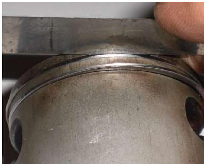
La mesure dans la zone de travail du cylindre donne l'usure cumulée du segment + du cylindre. La tolérance ici sera de 1 à 1,1 mm. Au delà, réaléser le moteur.
