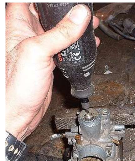
est parfaitement libre. Sur les petits moteurs remisés des années sans vidange d'essence, celle-ci s'est évaporée et a déposé un goudron, qui ne part pas au soufflage. Chauffer le gicleur à l'aide d'un briquet, ou sur un gaz de cuisinière, jusqu'à brûlure des goudrons (un petit nuage de fumée sort de l'intérieur du gicleur). Il n'y a pas de risque de chauffer jusqu'au changement de couleur (sans aller jusqu'au rouge !). Puis ramoner l'intérieur à l'aide d'un brin de fil électrique.
