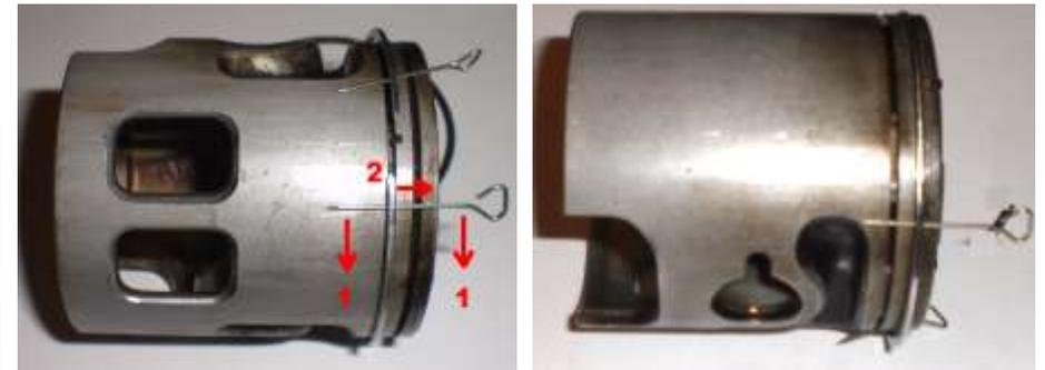
Le piston doit être présenté dans sa position normale de travail, c'est à dire lumière coté admission/clapets.
