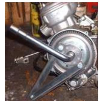
frein arrière, puis dévisser comme précédemment. Si rien ne vient, essayer de bloquer la rotation du volant avec une clé à sangle pour filtre à huile de voiture, ou une équerre (photo ci-dessus à droite).
