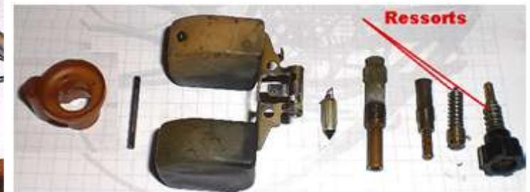
flotteurs (photo 4) en le faisant passer plusieurs fois, avec un mouvement de rotation, jusqu'à parfaite liberté du passage, sans aucun point dur. Nettoyer parfaitement la surface des flotteurs. Vérifier leur alignement.
