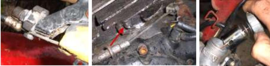
l'accrocher au cadre au bout de son câble. Dévisser les colliers de serrage des pipes du carburateur (1) retirer le tuyau d'alimentation d'essence (3) puis les tuyaux de trop plein (4 et 5). Pousser dans le sens de la flèche (6) pour dégager le
