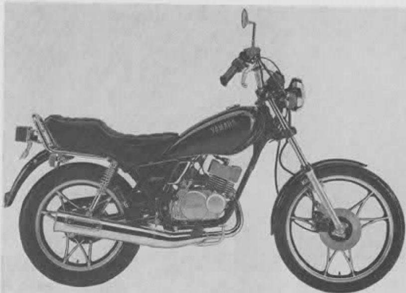
*Pour se donner une apparence de « grosse », la RX 80 SE s'offre un énorme pot d'échappement façon tromblon. Le moteur diffère notablement du RD et du DT par son allumage électronique, son carburateur Ø 18 mm, ainsi que par la culasse, le cylindre et le clapet d'admission (Photo RMT)*
