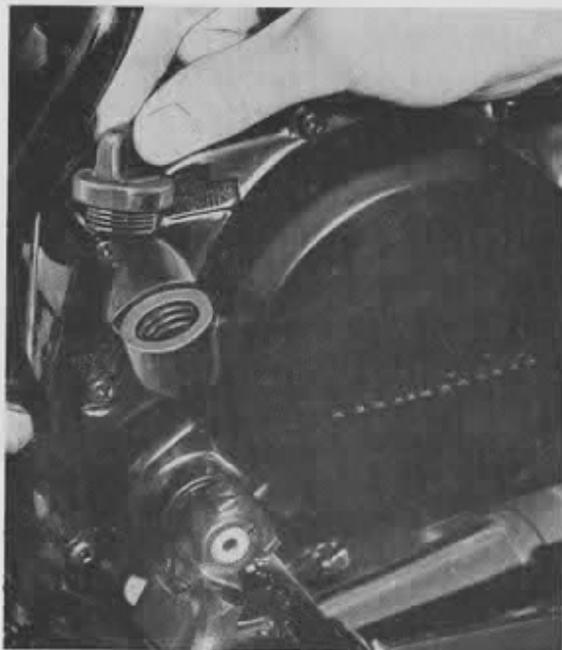
PHOTO 7 : Orifice de remplissage de la boîte de vitesses
