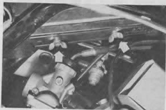
PHOTO 10 : Vis-papillon de filtre à air des modèles RX 80
