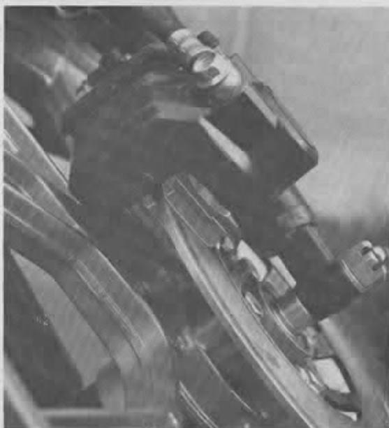
PHOTO 70 : Contrôle des plaquettes de frein
