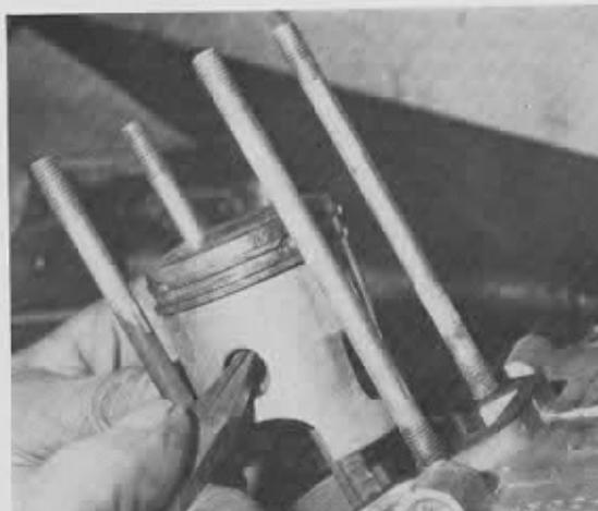
PHOTO 23 : Dépose des circlips d'axe de piston
