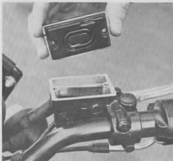
PHOTO 69 : Dépose du couvercle de réservoir de liquide de frein
