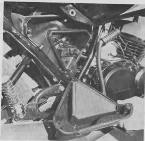
PHOTO 9 : Filtre à air des modèles RD et DT 80
