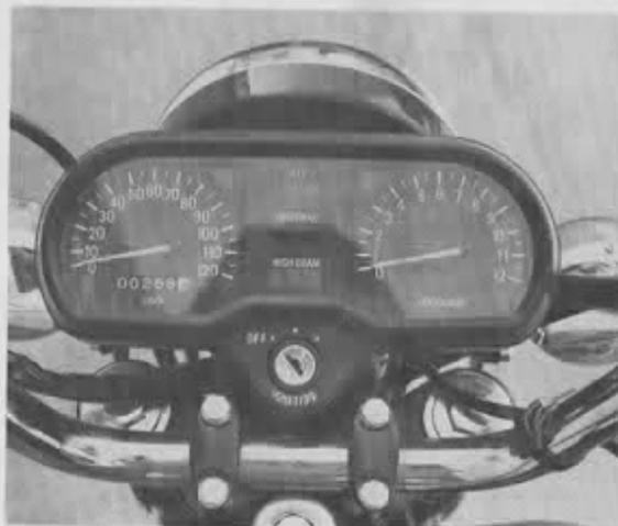
Le passager bénéficie de repose-pieds suspendus et d'un arceau de maintien. L'instrumentation comporte le même ensemble compteur - compte-tours que le RD 80, et en prime on trouve un témoin de niveau d'huile de graissage séparé. Curieusement la moto est dépourvue de béquille centrale et se contente d'une latérale. Quant au réservoir d'essence, il ferme à clé.
