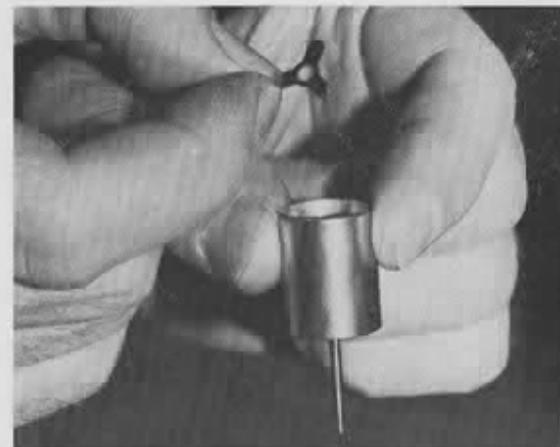
**PHOTO 12 :** Pièce à interposer entre circlip d'aiguille et ressort de boisseau (étoile ou rondelle selon type de carburateur)
