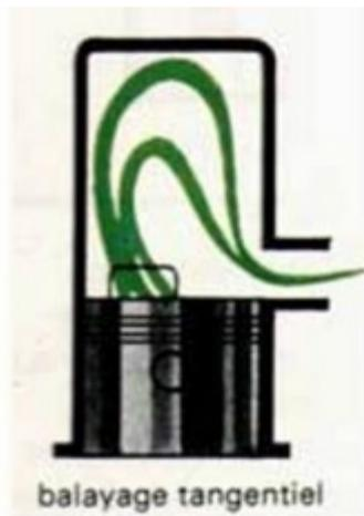
Expérimenté par l'Allemand Schnürle en 1931, il se caractérise par le dédoublement du canal de transfert. Les deux courants de gaz se rencontrent le long de la paroi opposée à l'échappement et remontent ensuite vers la culasse. Ce système permet d'utiliser des pistons plats et il assure un meilleur balayage. Les gaz frais étant au contact des parois, on évite ainsi tout mélange avec les gaz brûlés.
