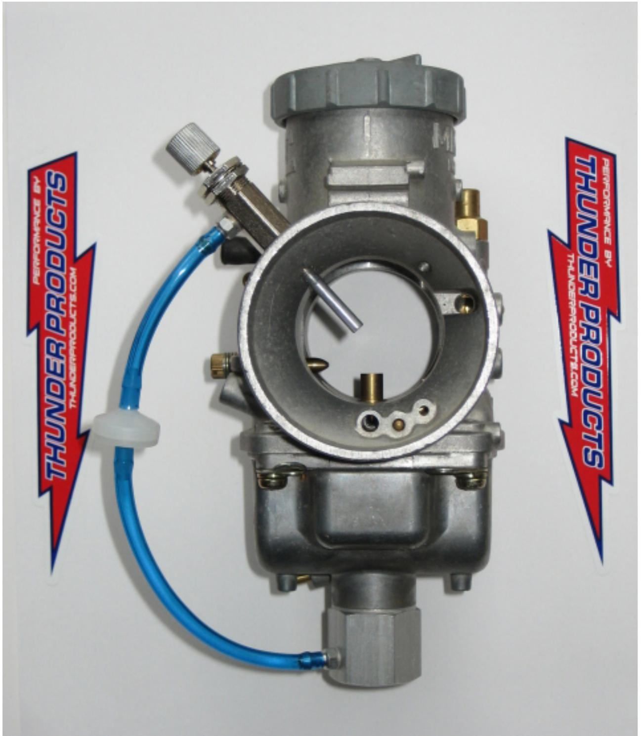
Vu de derrière, le power jet avec sa durit bleu.
