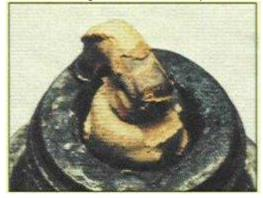
Électrodes Endommagées : Électrodes brûlées, vitreuses. Causes : Température de fonctionnement élevée, surchauffe.
