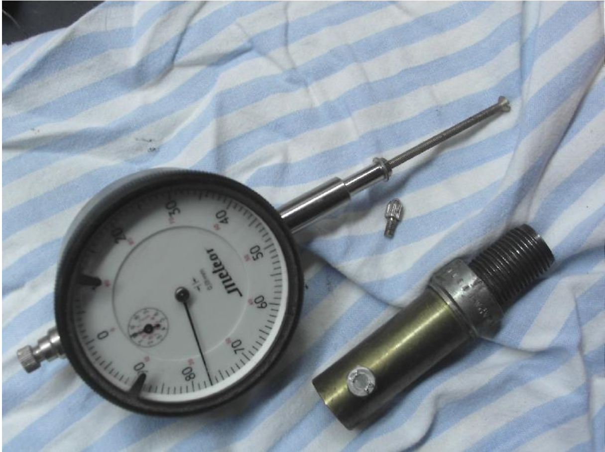
14 Mise en place du comparateur à la place de la bougie:
