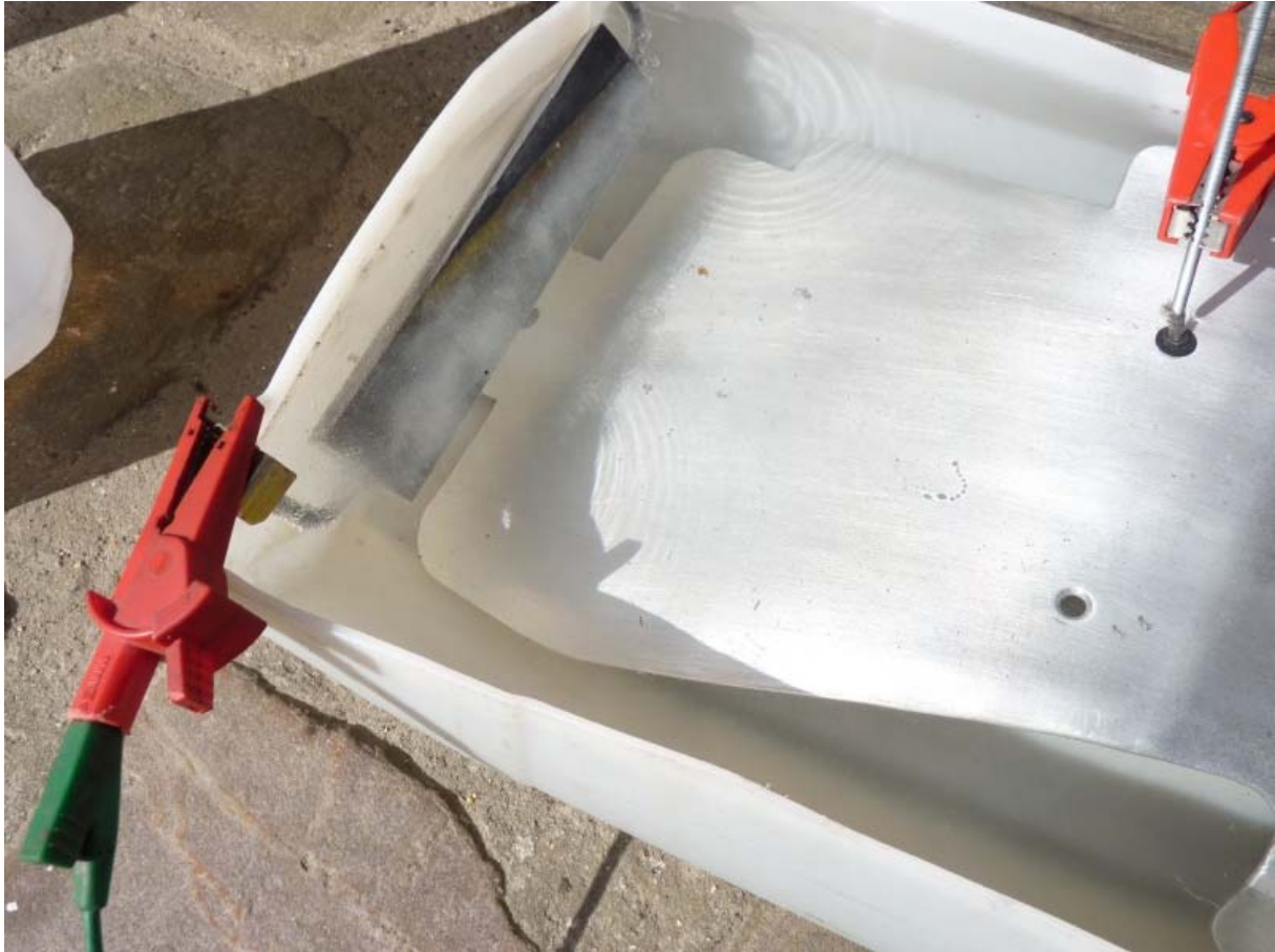
La pièce en sortie de bain et neutralisation, pièce à coté d'un bout de tôle alu brute:
