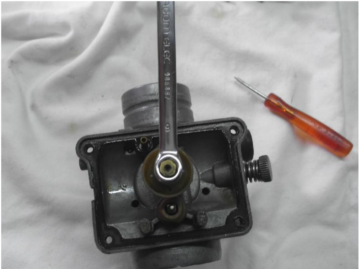
15 Démontage du gicleur principal avec une clé de 8 et une de 6:
