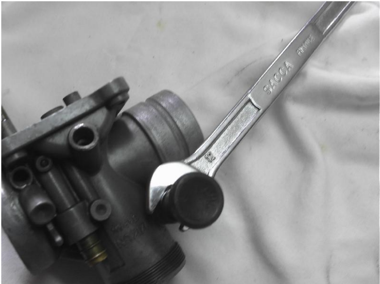
20 Démontage du starter avec une clé de 12:
