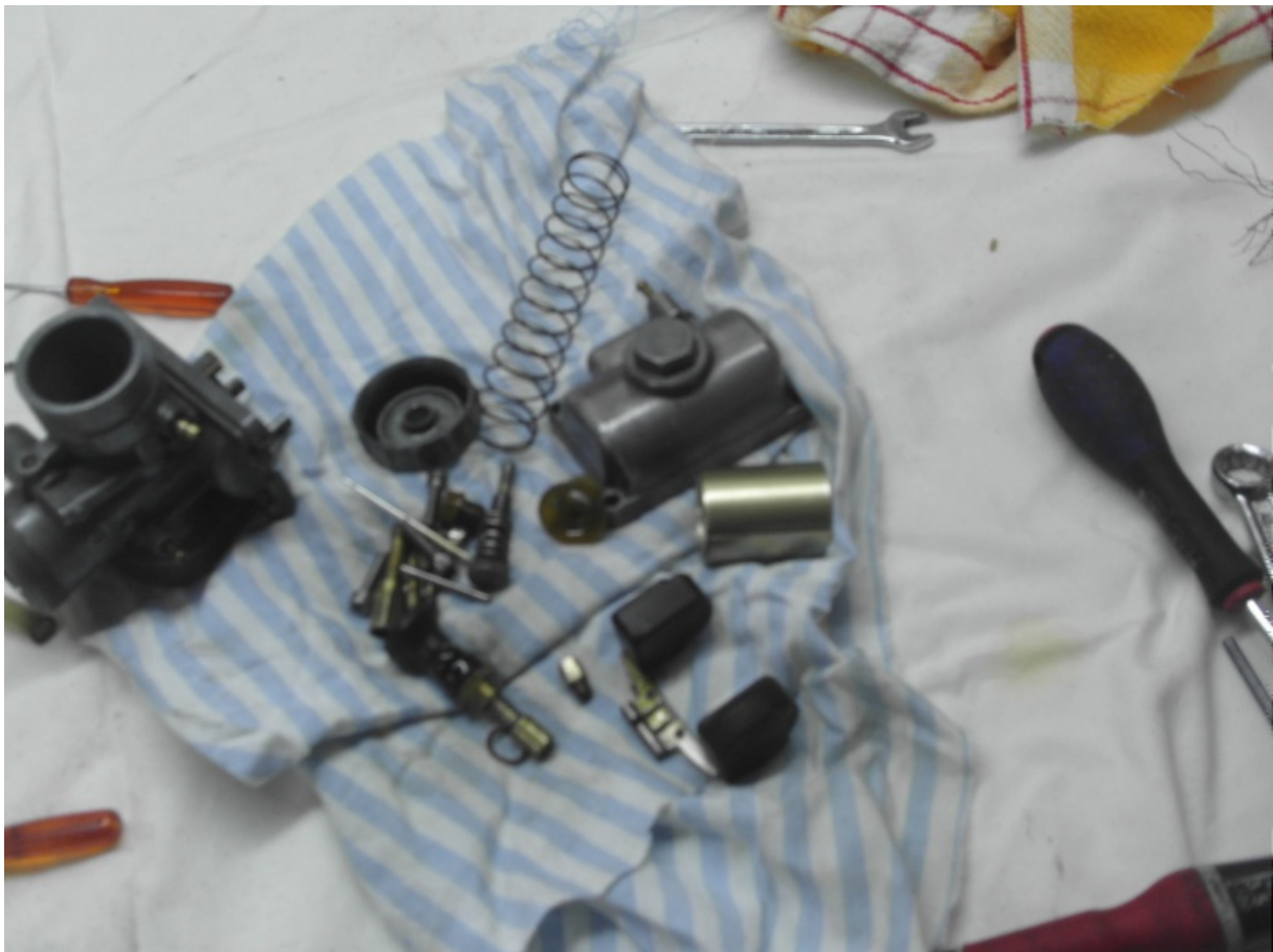
42 Souffler dans les canaux pour retirer les saletés et sécher:
