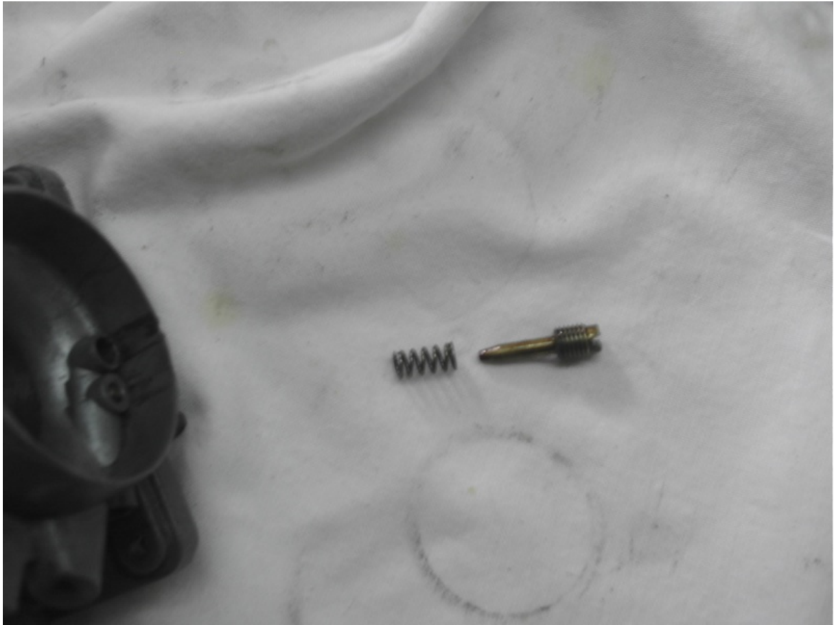
20 Démontage du starter avec une clé de 12:
