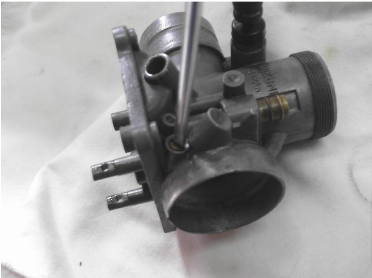
19 La vis de richesse et son ressort anti desserrage:
