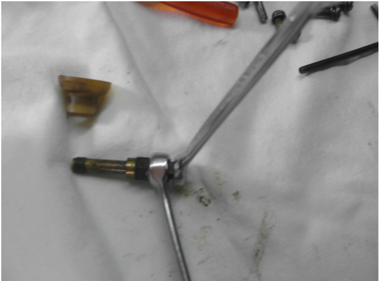
15 Démontage du gicleur principal avec une clé de 8 et une de 6:
