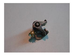
et une des pannes trés difficile a trouver: grippage de l'axe,même sur rupteur NEUF!
