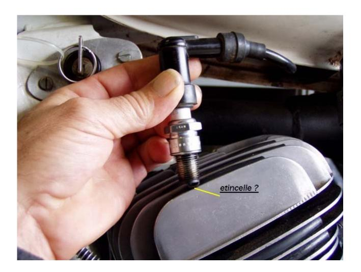
verification aussi de l'anti-parasites,en l'enlevant,et en approchant le bout de fil restant de la culasse (presence d'arc où non )et longueur de l'arc:6mm au moins(expliqué plus bas:puissance d'allumage)
