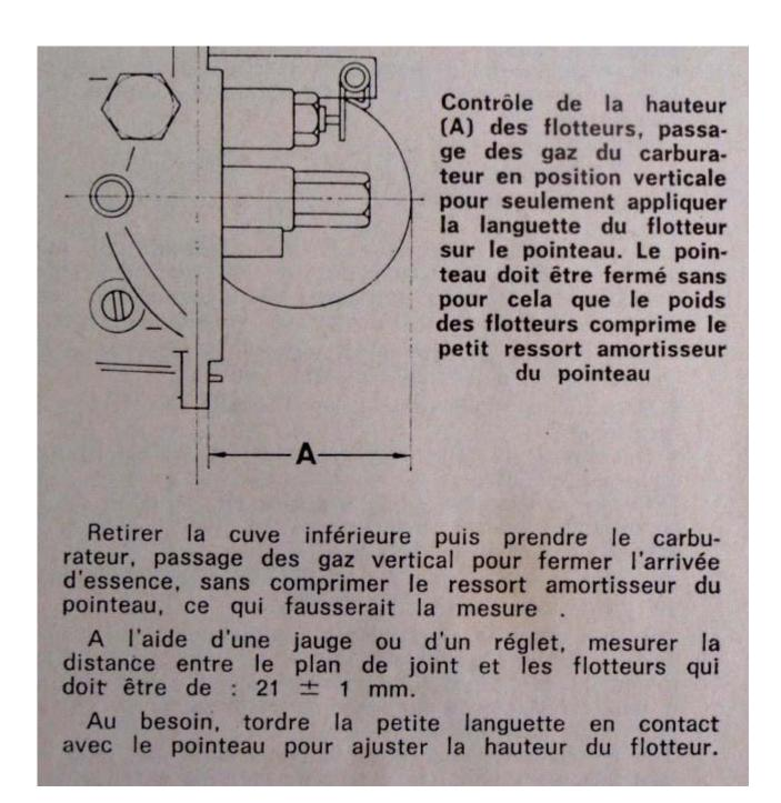
on peut verifier aussi la bonne fermeture du pointeau (souffler par l'arrivée d'essence, et remonter les flotteurs doucement, jusqu'a la fermeture du conduit.la hauteur des flotteurs doit etre OK)
