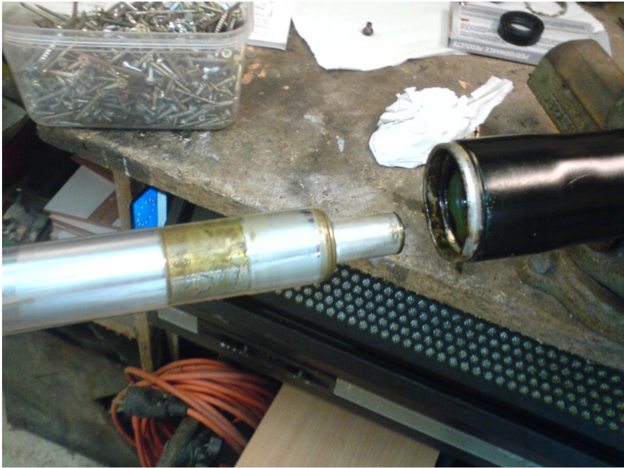
chasser a l'aide d'un tournevis plat le cache métallique,
