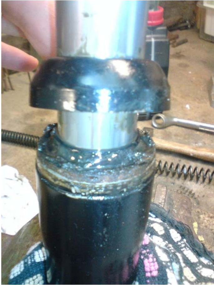
chasser a l'aide d'un tournevis plat le cache métallique,
