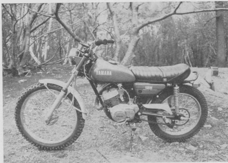
Le modèle « AT 2 E » avec le système « Torque Induction » et la jante avant de 21 pouces (Photo RMT)
