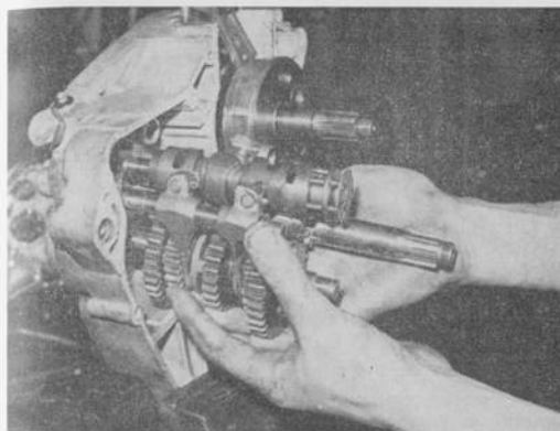
Tout l'ensemble se retire du demi-carter gauche (Photo RMT)
