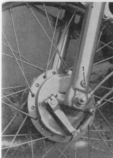
Moyeu frein avant simple came 1. Vis de vidange d'un amortisseur de la fourche avant (Photo RMT)
